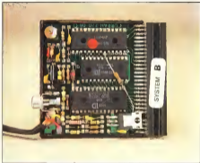
Il circuito integrato del TV è il chip che genera un segnale di alta intensità per l'audio ed una serie di linee di controllo per il processore.
